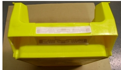
Abbildung 4 - KLT-Behälter mit RFID-Transpondern
