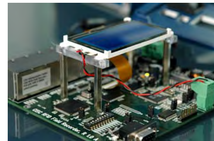
Einblick in den CISC-RFID-Field-Recorder - nur eines von CISC's Produkten zur Evaluierung von RFID-Systemen und -Anwendungen.
