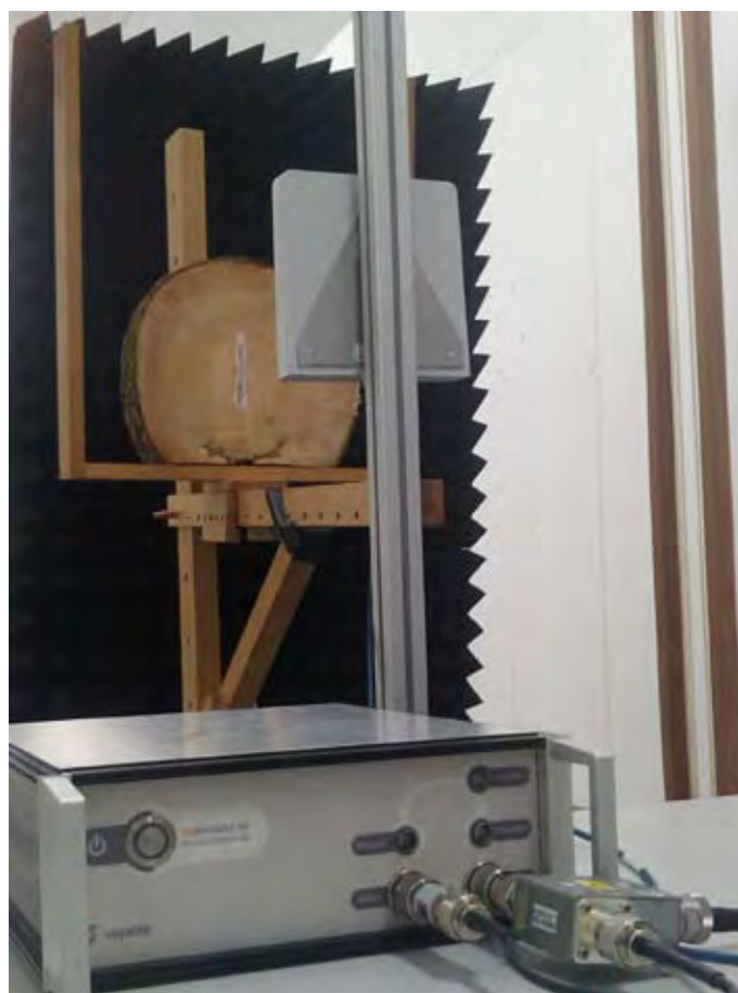
Messaufbau zur Reichweitenbestimmung eines auf Holz montierten UHF-Transponders
