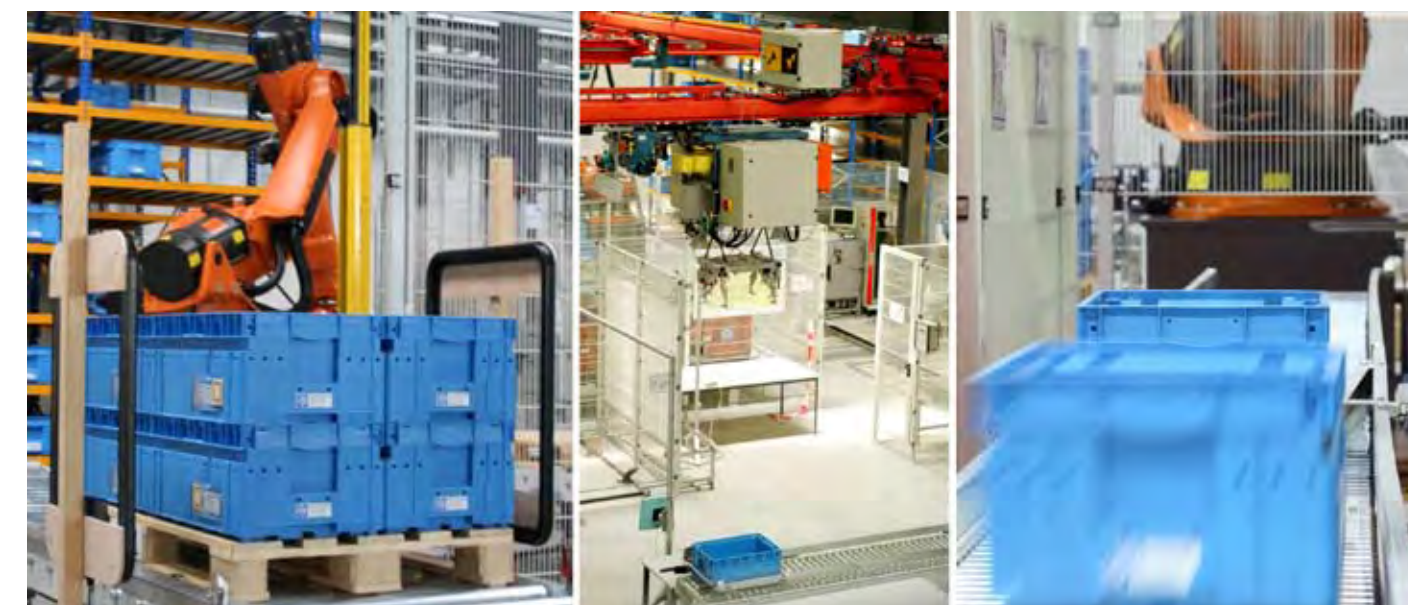
fml-Versuchsanlage: Transporteinheiten steuern (Fördertechnik-)Module
