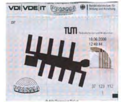
Prototyp eines Fahrscheins mit auf der Rückseite aufgedrucktem polymeren RFID-Tag, dessen metallische Antenne durch den Ausschnitt im Fahrschein sichtbar wird.
