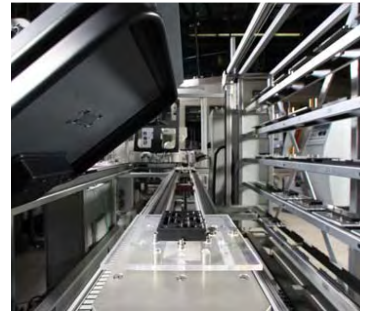
Beschreiben/Auslesen des im Produkt integrierten RFID-Transponders durch eine am Produktionssystem installierte Antenne Quelle: CoTeSys/Kurt Fuchs
