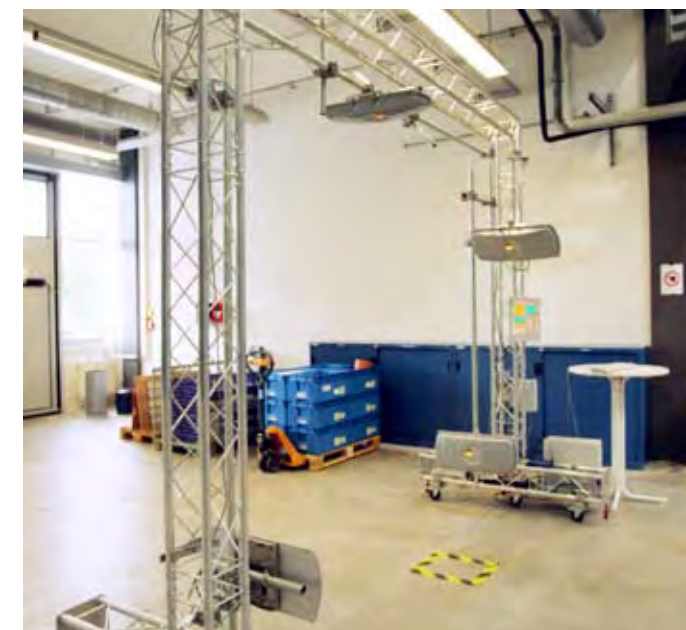
Gate zur RFID-Pulkerfassung
