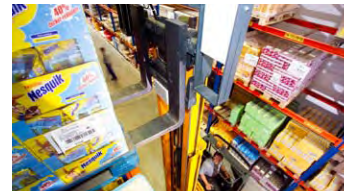
Extern angebrachte RFID-Reader - zwischen den Gabeln, am Gabelrücken oder seitlich am Lastschutzgitter - erkennen Transponder an Waren oder Lagerplätzen.
