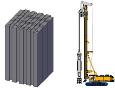
Abb. 3 : 3D-Blockkonstruktion mit Fräsgerät
