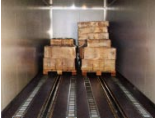
Abb. 1: Rollenförderer mit Kettenantrieb
