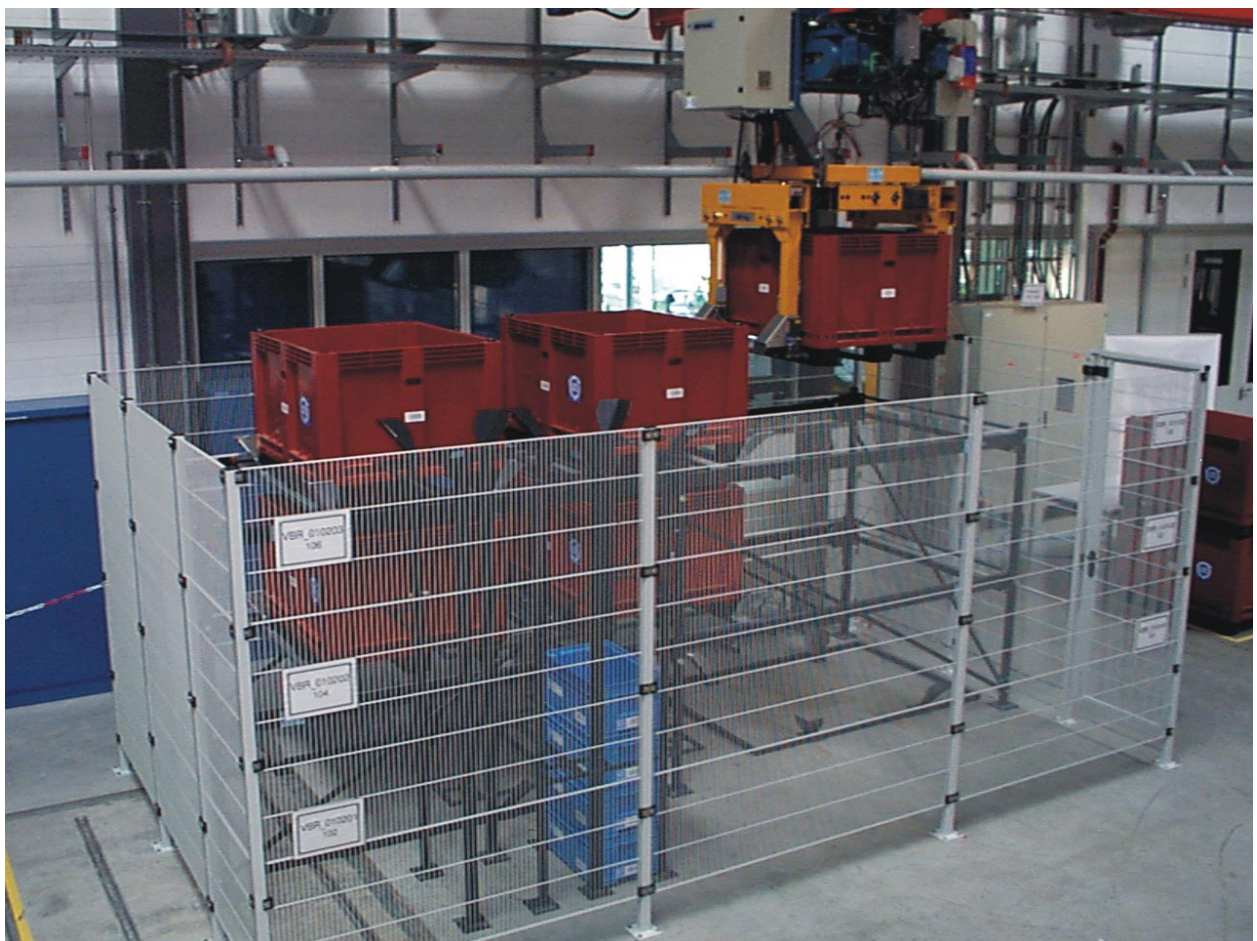
Bild 1: Grundmodul und Prototyp des Verschiebebodenregals in der Versuchshalle des Lehrstuhls fml
