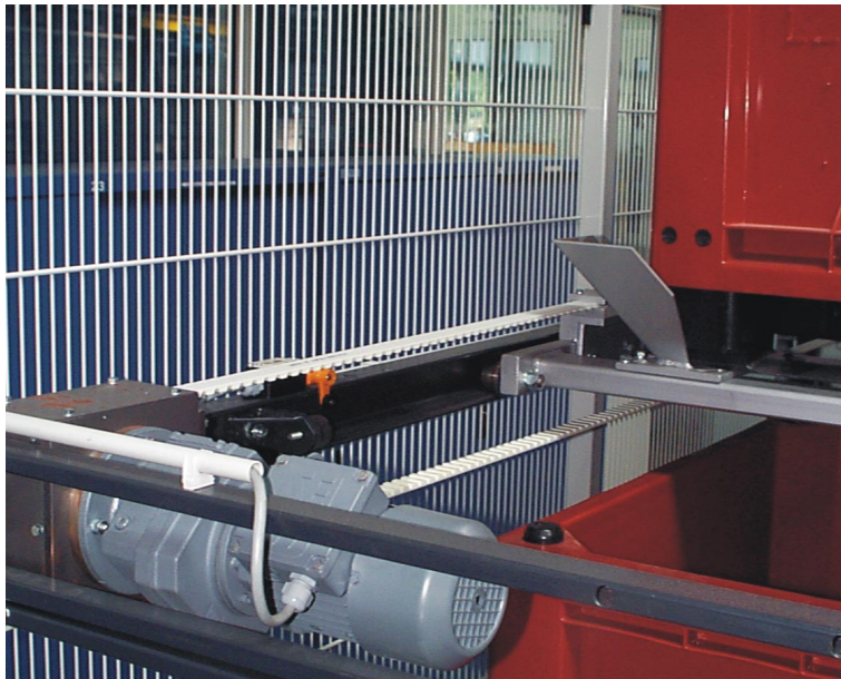
Bild 2: Verschiebeboden und Zahnriemenantrieb
