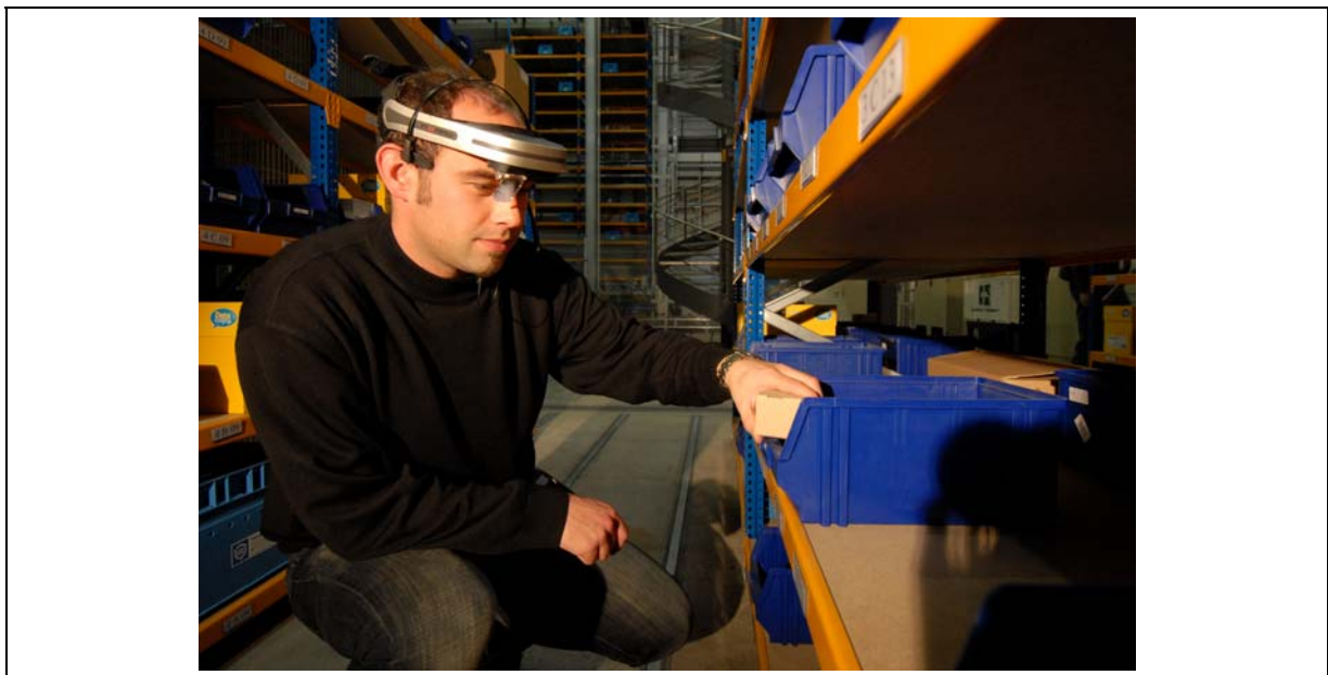
Abbildung 7: Pick-by-Vision – Kommissionierung mit einer Datenbrille
