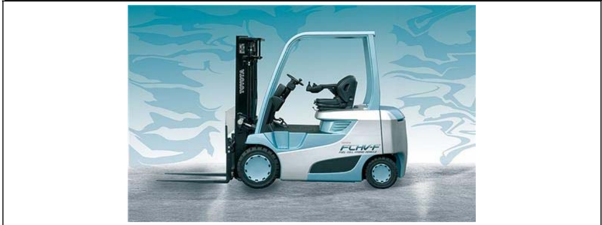
Abbildung 3: Stapler mit Brennstoffzellen-Hybrid-Technologie von Toyota (Bild: Toyota)
