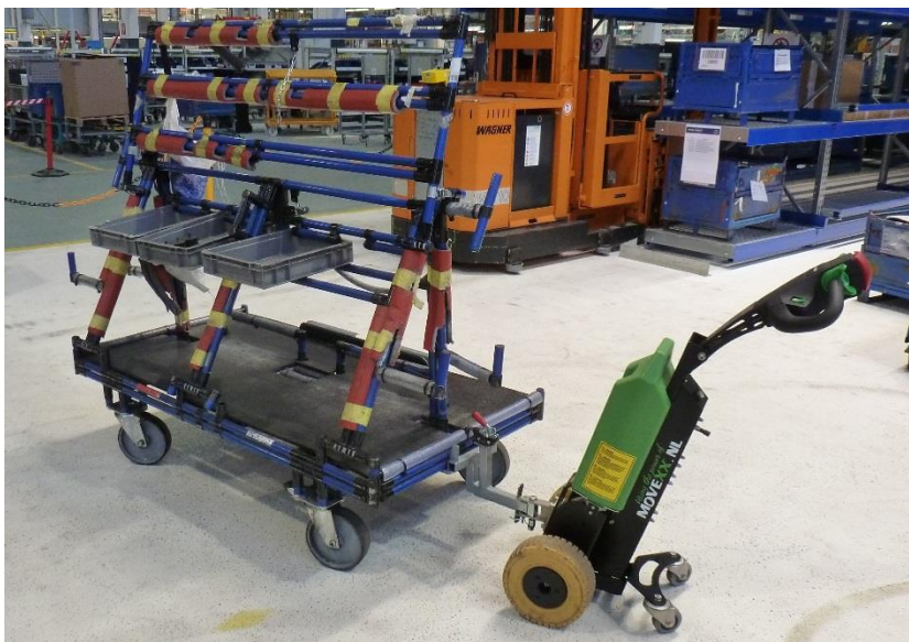
Bild 4: Exemplarischer Einsatz einer Schiebehilfe zur Reduktion der körperlichen Belastung
