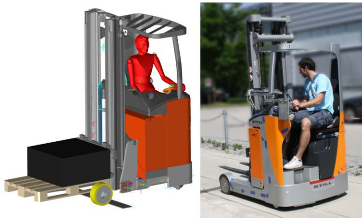
Bild 1: Untersuchungsobjekt: Schubmaststapler als Simulationsmodell und auf der Teststrecke (Bilder: fml)
