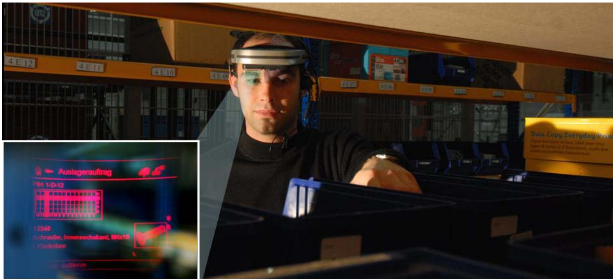
Abb. 4: Kommissionieren mit einem monokularen Durchsichtdisplay und die angezeigten Daten (kleines Bild)
