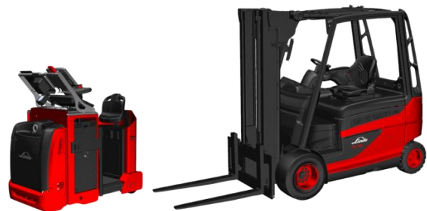
Abbildung 2: Routenzugschlepper und Gabelstapler mit Brennstoffzellensystem
